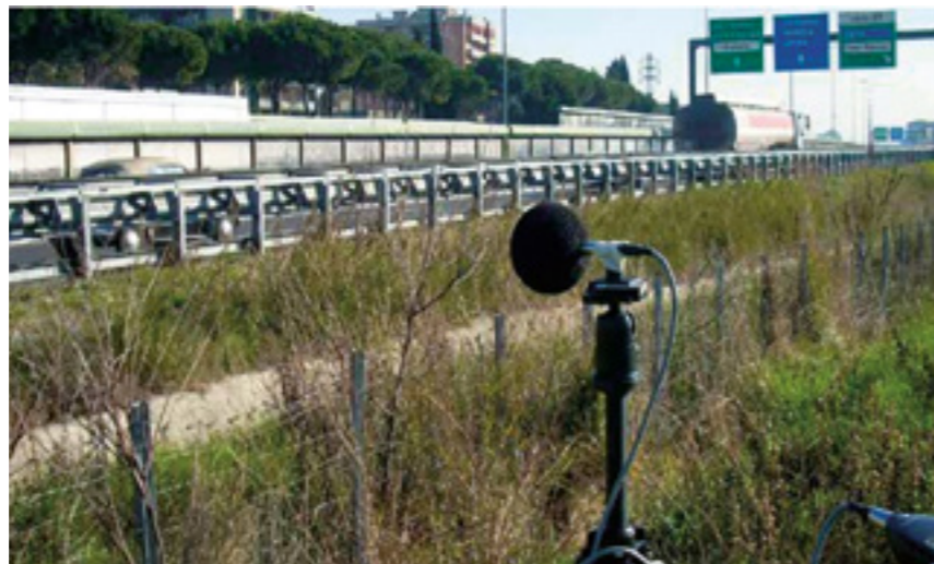
Figura 1 - Misura di rumore da traffico stradale [3].
